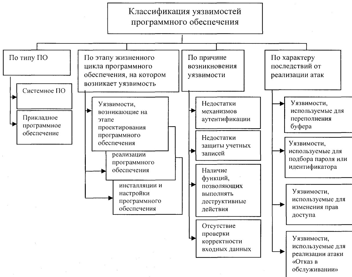
"Рисунок 4. Классификация уязвимостей программного обеспечения"
