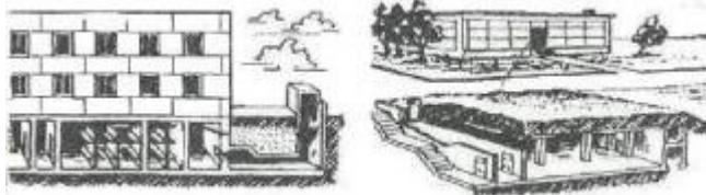
**УБЕЖИЩА** представляют собой сооружения, обеспечивающие наиболее надежную защиту укрываемых в них людей от воздействия всех поражающих факторов ядерного взрыва, отравляющих веществ и бактериальных
