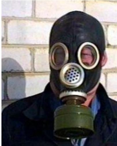
Для защиты населения наибольшее распространение получили фильтрующие противогазы ГП-5 (ГП-5М) и ГП-7 (ГП-7В). Гражданский противогаз ГП-5 предназначен для защиты человека от попадания в органы дыхания, на глаза и лицо радиоактивных, отравляющих, аварийно химически опасных веществ и бактериальных средств. Принцип защитного действия основан на предварительной очистке (фильтрации) вдыхаемого воздуха от вредных примесей.
